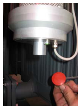
9. Alla fine del montaggio togliere il tappo nella parte inferiore dell'essiccatore. Seguire le istruzioni d'uso del fornitore nella sezione 2 di questo manuale, per l'attivazione dello strumento.
