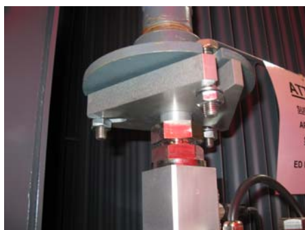
7. Assicurarsi anche che i due dadi sotto la flangia siano fissati correttamente
